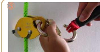
QQ 本体専用の付属カラビナにショックアブソーバースリングを使用して、ハーネスの支点に接続します。
