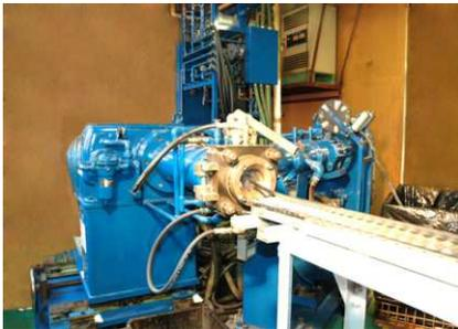
押し出し機にて各種断面の紐状ゴムの製造が可能です。CAD 図面も提出可能です。
