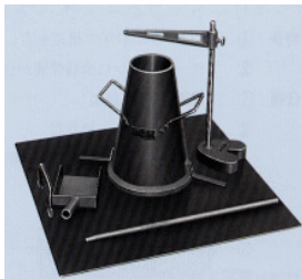
コンクリートスランプ試験器 標準供試体の施工軟度を測定します
